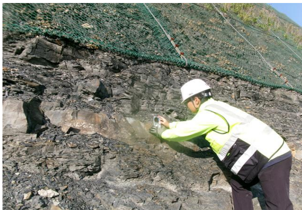
절리면 경사/경사방향 측정
